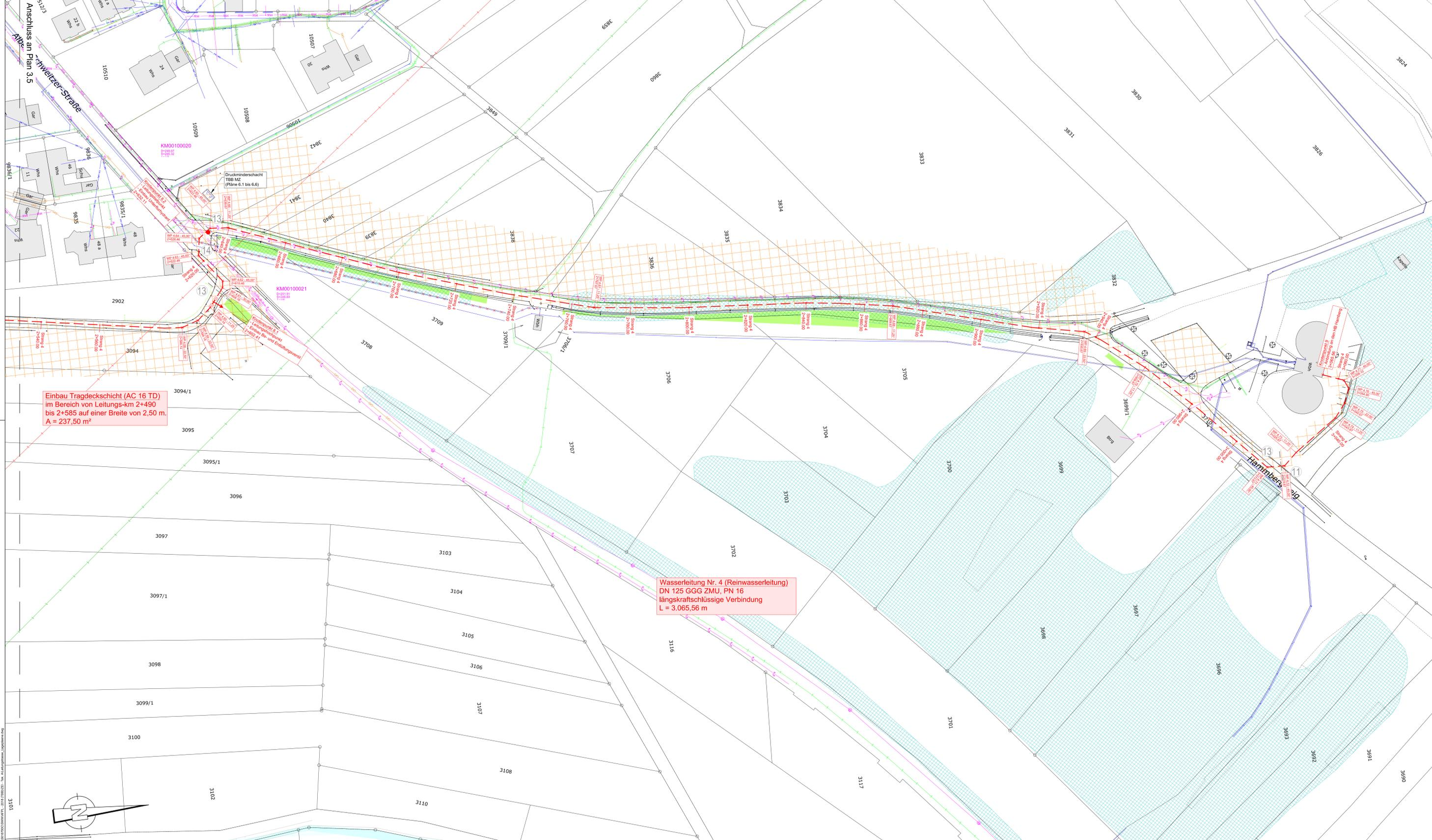
Einbau Tragdeckschicht (AC 16 TD) im Bereich von Leitungs-km 2+490 bis 2+585 auf einer Breite von 2,50 m. A = 237,50 m<sup>2</sup>
